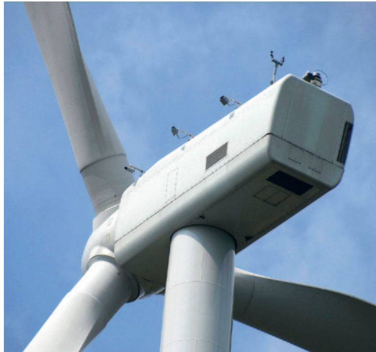
Die Ultraschallgeräte zu Vergrämung von Fledermäusen wurden bei diesem Pilotversuch in den USA an der Seite der Gondel befestigt.
